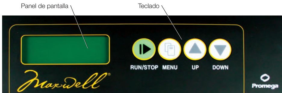
Figura 2. Panel de la pantalla de Maxwell® 16 Instrument. Panel de la pantalla LCD y teclado, que incluye los botones Run/Stop, Menu y los botones de desplazamiento hacia arriba y hacia abajo.
