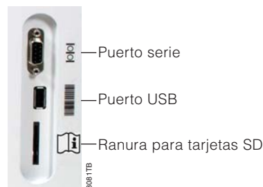
Figura 5. Puertos de comunicaciones en el lateral del instrumento. Esta vista lateral muestra los puertos de comunicación del instrumento. El puerto USB se utiliza para conectar el lector de códigos de barras.
