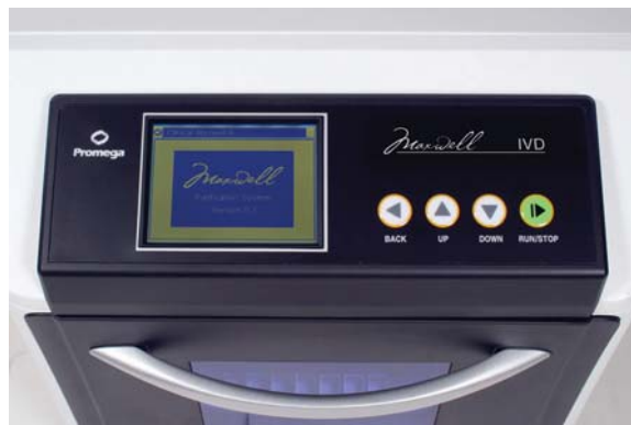
Figura 3. Pantalla táctil y teclado para navegar por las diferentes pantallas del Maxwell® 16 IVD Instrument. Dispone de las mismas selecciones de botones en el teclado y en la pantalla. Estos dos grupos de botones pueden utilizarse para navegar dentro de las pantallas y entre una pantalla y otra. Los botones Back y Run/Stop permiten la navegación entre pantallas. Botones Up y Down sirven para navegar dentro de una pantalla.
