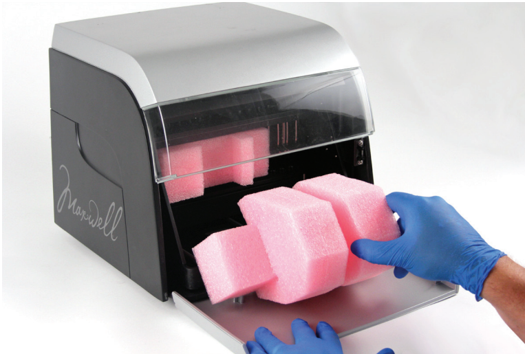
Figure 9. Retirez les deux morceaux de mousse situés à l'intérieur de l'appareil.
