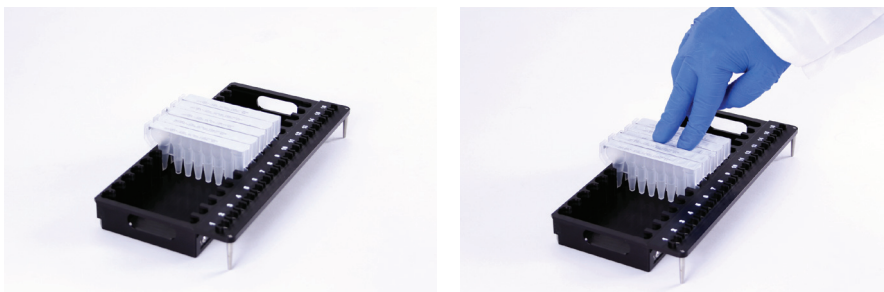
Figure 49. Placez les cartouches dans le portoir de la plateforme et poussez fermement pour les engager en place.
