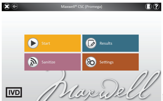
Figure 62. Écran d'Accueil du Maxwell® CSC. Sélectionnez Results (Résultats) pour ouvrir l'écran « Reports » (Rapports) du Maxwell® CSC, à partir duquel les rapports d'extraction de tous les protocoles, procédures d'entretien et tâches système qui ont été exécutés peuvent être visualisés.
