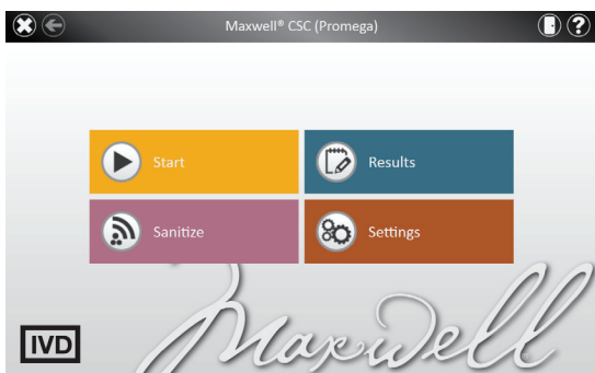
Figure 28. Écran d'Accueil du Maxwell ® CSC. Sélectionnez « Settings » (Paramètres) pour ouvrir l'écran correspondant du Maxwell ® CSC, où les options de saisie des code-barres peuvent être réglées.
