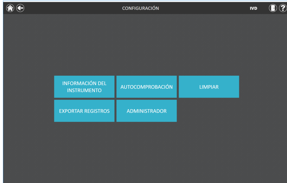
Figura 21. Pantalla “Configuración” de Maxwell® CSC 48. El botón Administrador solo estará visible si el operador que tenga iniciada la sesión actualmente dispone de derechos de nivel de administrador en el software de Maxwell® CSC 48.
