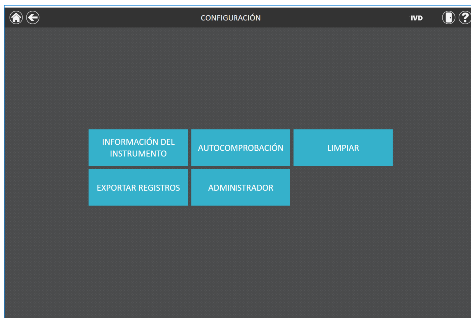
Figura 17. Pantalla “Configuración” de Maxwell® CSC 48. Desde esta pantalla, puede pulsar Limpiar para descargar los émbolos que puedan quedar en la barra de émbolo tras ejecutar un método fallido.
