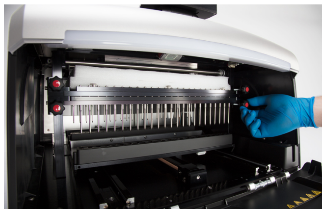
Figura 63. Colocación de los topes de plástico. Mueva las barras de imán y de émbolo hacia arriba, y asegure los cuatro tornillos de envío a ambos lados de las barras.
