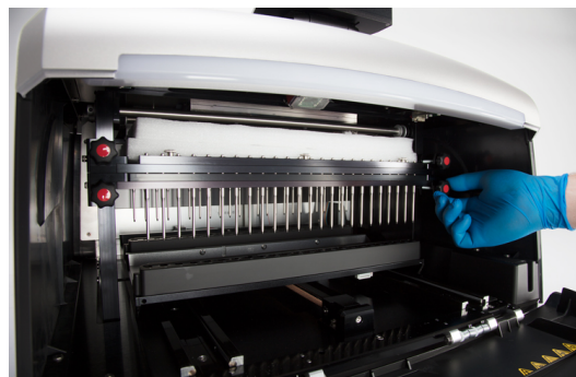
Figura 7. Extracción de las dos piezas de espuma del interior del instrumento. Panel A. Extraiga la pieza de espuma frontal. Panel B. Extraiga los cuatro tornillos de envío de los lados de las barras de imán y de émbolo frontales.
