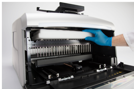
Figura 8. Extracción de la espuma superior del instrumento. Mueva las barras de imán y de émbolo hacia abajo para extraer la pieza de espuma superior.
