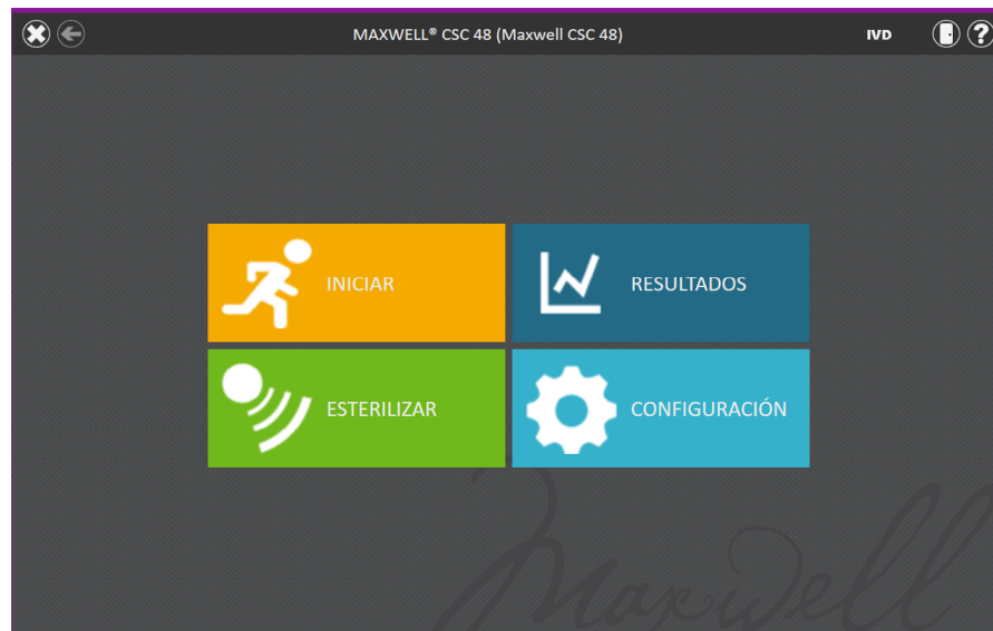
Figura 54. Pantalla “Inicio” de Maxwell® CSC 48. Al seleccionar Resultados , se abrirá la pantalla “Resultados” de Maxwell® CSC 48, desde la que se pueden consultar los informes de extracción de todas las ejecuciones de métodos.
