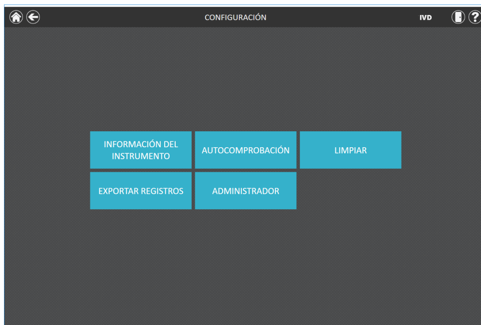
Figura 14. Pantalla “Configuración” de Maxwell® CSC 48. Desde esta pantalla es posible acceder a varias funciones específicas del instrumento. El botón Administrador solo se mostrará en el caso de las cuentas de usuario de Windows® con acceso de nivel de administrador al software de Maxwell® CSC 48.
