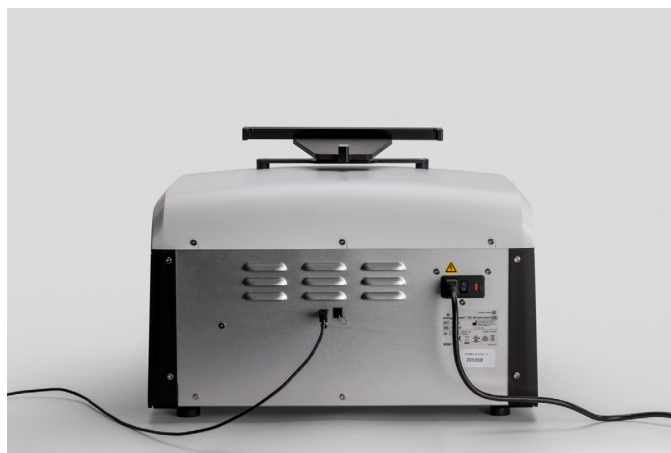
Figura 10. Conexión del Tablet PC a la parte trasera de Maxwell® CSC 48 Instrument.
