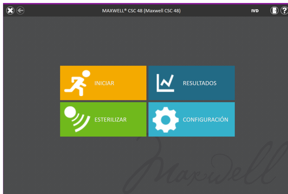
Figura 57. Pantalla “Inicio”. Al seleccionar el botón Esterilizar , empieza el proceso de tratamiento mediante UV de Maxwell® CSC 48 Instrument.
